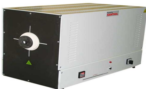
Рисунок 1 – Трубчатая электропечь СУОЛ-044 12-М2 [5]
