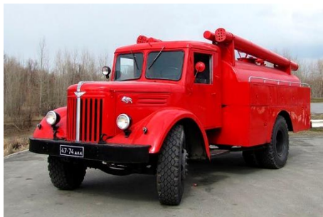
Рисунок 5 – Пожарная автоцистерна модификации ПМЗ на базе шасси ЗИС
